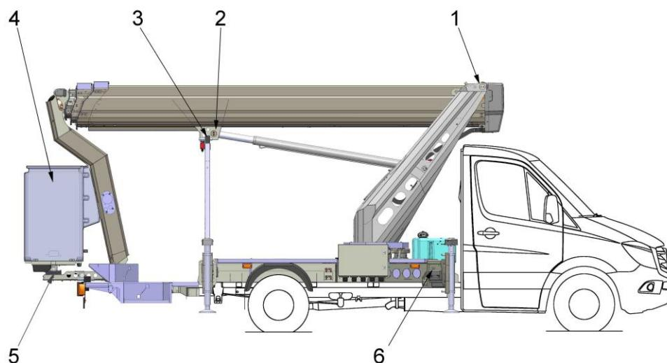
Der Ruthmann-Steiger TBR 250 wird durch zwei voneinander unabhängige, in Reihe geschaltete Isolierstrecken gegen Erde isoliert.
