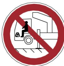
⇒ Im ausgehobenen Zustand muss das Fahrerhaus leer sein und lastfrei bleiben. D. h. bei ausgehobener Vorderachse ist der Aufenthalt im Fahrerhaus verboten! Zuladungen im Fahrerhaus bzw. zusätzliche Lasten oder Anbauten am Fahrerhaus sind ebenfalls verboten! Vordere Aufritte dürfen nicht benutzt werden!
