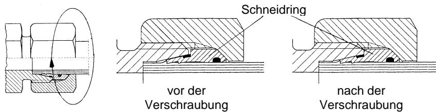
Der Schneidring wird auf Block montiert. Beim Anziehen der Überwurfmutter den Verschraubungsstutzen mit einem Schraubenschlüssel gegenhalten.
