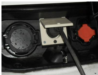
Externe 220V-Versorgung angeschlossen (Kühler des Fahrzeugs) für die Stromversorgung des Ladegeräts
